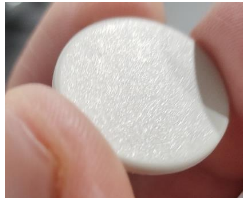
RFID-Tag, unten (in Richtung des Brettes)
