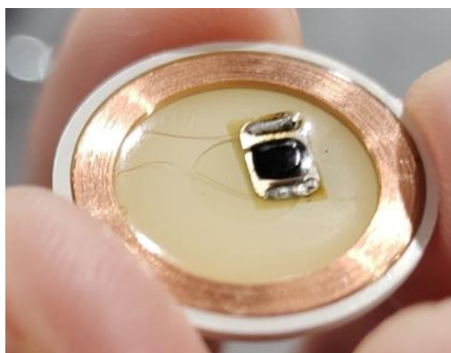
Étiquette RFID, à l'endroit (vers le joueur d'échecs)
