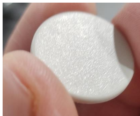
Étiquette RFID, à l'envers (vers l'échiquier)
